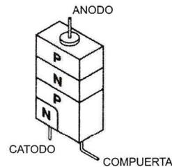
**OPERACION DEL SCR** - si el ánodo de un scr se vuelve mas positivo que el cátodo las dos uniones pn mas alejadas se polarizan directamente. Sin embargo, la unión pn central, se polariza inversamente y la corriente no puede fluir. Una pequeña corriente de compuerta directa polariza la unión central pn y permite que fluya una corriente mayor a través del dispositivo. ¡el scr se mantiene encendido incluso si la corriente de compuerta es removida!. (Hasta que se desconecte la energía).
