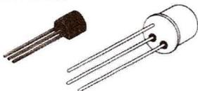
Los scr de baja corriente incluyen aquellos que conmutan desde 1 amperre y 100 volts.
