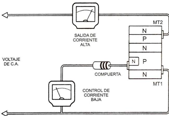
Los dos scrs en paralelo están cara a cara en dirección opuesta en el triac (contra paralelo). Cuando se utiliza para conmutar corriente alterna, el triac permanece activo únicamente cuando la compuerta recibe corriente. Remueva la corriente de compuerta y se desactiva cuando la c.a. Pasa a cero volts.
