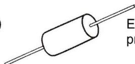
El diac es un dispositivo de tres capas similar a un transistor de unión pnp pero sin la terminal de base. Puede conmutar voltaje de c.a.
