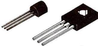
Los triac de baja corriente conmutan arriba de 1 amperes y varios centenares de volts. También se utilizan otros encapsulados.
