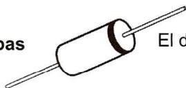
El diodo de 4 capas es un scr sin compuerta. Conmuta voltaje de c.c.
