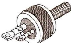
¡Estos scr pueden conmutar mas de 2 500 amperres y arriba de varios miles de volts! Estos controlan motores, luces, aparatos, etc.
